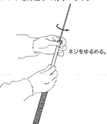
②ファイバーエレメントを金具の中に入れる長さにより周波数が変化します。エレメントを伸ばすと共振周波数が下がり、逆に緩めると共振周波数は上がります。通常の使用状態では、ファイバーエレメントを中間（最短から約5cm伸ばす）にしたときに、アマチュアバンドの中心付近がSWR最良点となるように設定しています。
