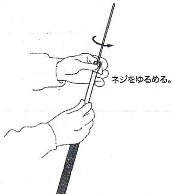
②ファイバーエレメントを金具の中に入れる長さにより周波数が変化します。エレメントを伸ばすと共振周波数が下がり、逆に緩めると共振周波数は上がります。通常の使用状態では、ファイバーエレメントを中間（最短から約5cm伸ばす）にしたときに、アマチュアバンドの中心付近がSWR最良点となるように設定しています。
