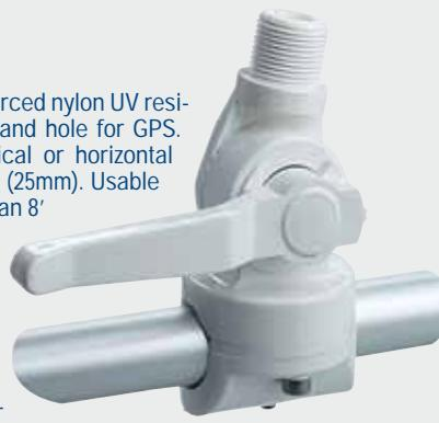
Rotule renforcée en nylon traité anti-UV, avec blocage par levier et passe-câble pour GPS. Fixation horizontale ou verticale sur balcon diamètre de 22 a 25 mm. Pour antennes de maximum 2.40 mts en fixations autoportantes. Filetage standard 1"x14.
