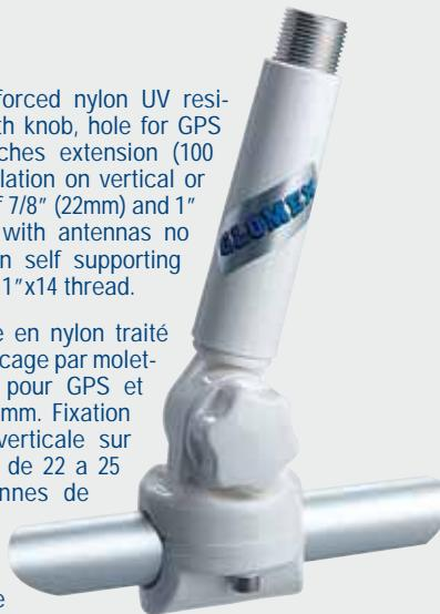
Rotule renforcée en nylon traité anti-UV, avec blocage par molette, passe-câble pour GPS et rallonge de 100 mm. Fixation horizontale ou verticale sur balcon diamètre de 22 a 25 mm. Pour antenne de maximum 2.40 mts en fixations autoportantes. Filetage standard 1"x14.
