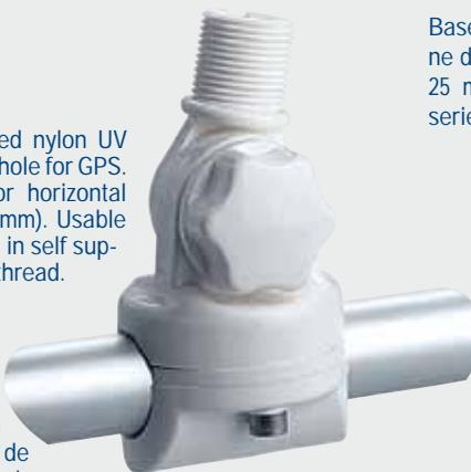
Rotule renforcée en nylon traité anti-UV, avec blocage par molette et passe-câble pour GPS. Fixation horizontale ou verticale sur balcon diamètre de 22 a 25 mm. Pour antennes de maximum 2.40 mts en fixations autoportantes. Filetage standard 1"x14.
